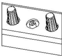
L'intensité du spray pour les instruments peut être réglée sous l'unit praticien. La position des groupes électrovannes (triples) pour chaque instrument est en fonction de l'instrument dans les supports du carquois. L'intensité du spray peut être réglée à l'aide des boutons ou molettes. L'air de propulsion pour la turbine ou l'air de refroidissement pour le moteur peut être réglé à l'aide d'un tournevis cruciforme.
