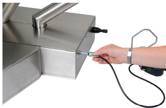
Introduire le câble de la pédale filaire S-N2 dans la douille pour le raccordement sur la base du fauteuil. Placer au préalable l'écrou-raccord sur le câble.
