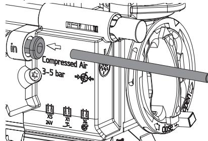
**i** Pour débrancher le tuyau flexible haute pression de la vanne de sélection de crachoir, il suffit de repousser le manchon noir du raccord d'air comprimé vers l'intérieur.
